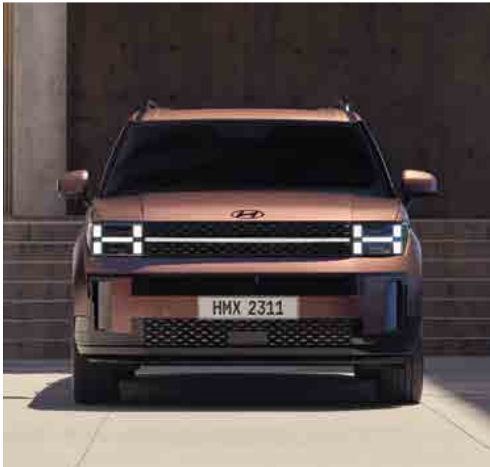
Н-образные фары головного света (светодиодные, проекционного типа)
